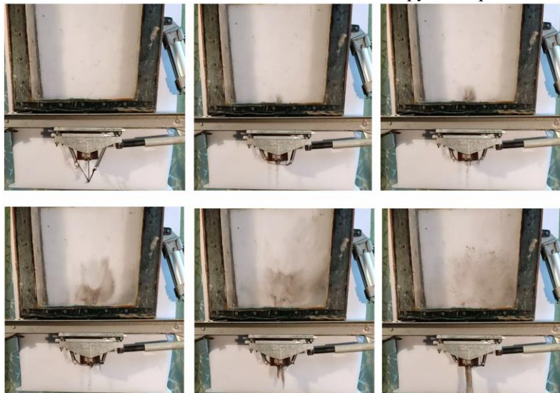
Рисунок 5. Срабатывание катапульты при имитации начала разливки в случае отсутствия твердой корки на поверхности стартовой смеси
