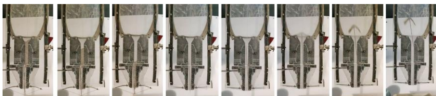
Рисунок 3. Картина процесса взаимодействия стрелы с утолщенной головной частью при вязком слое перемычки
