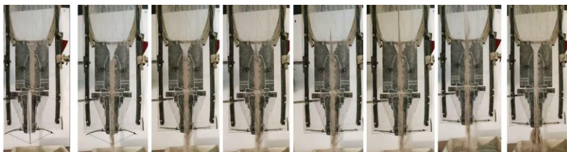
Рисунок 2. Картина процесса взаимодействия стрелы катапульты с малым лобовым сопротивлением при вязком слое перемычки
